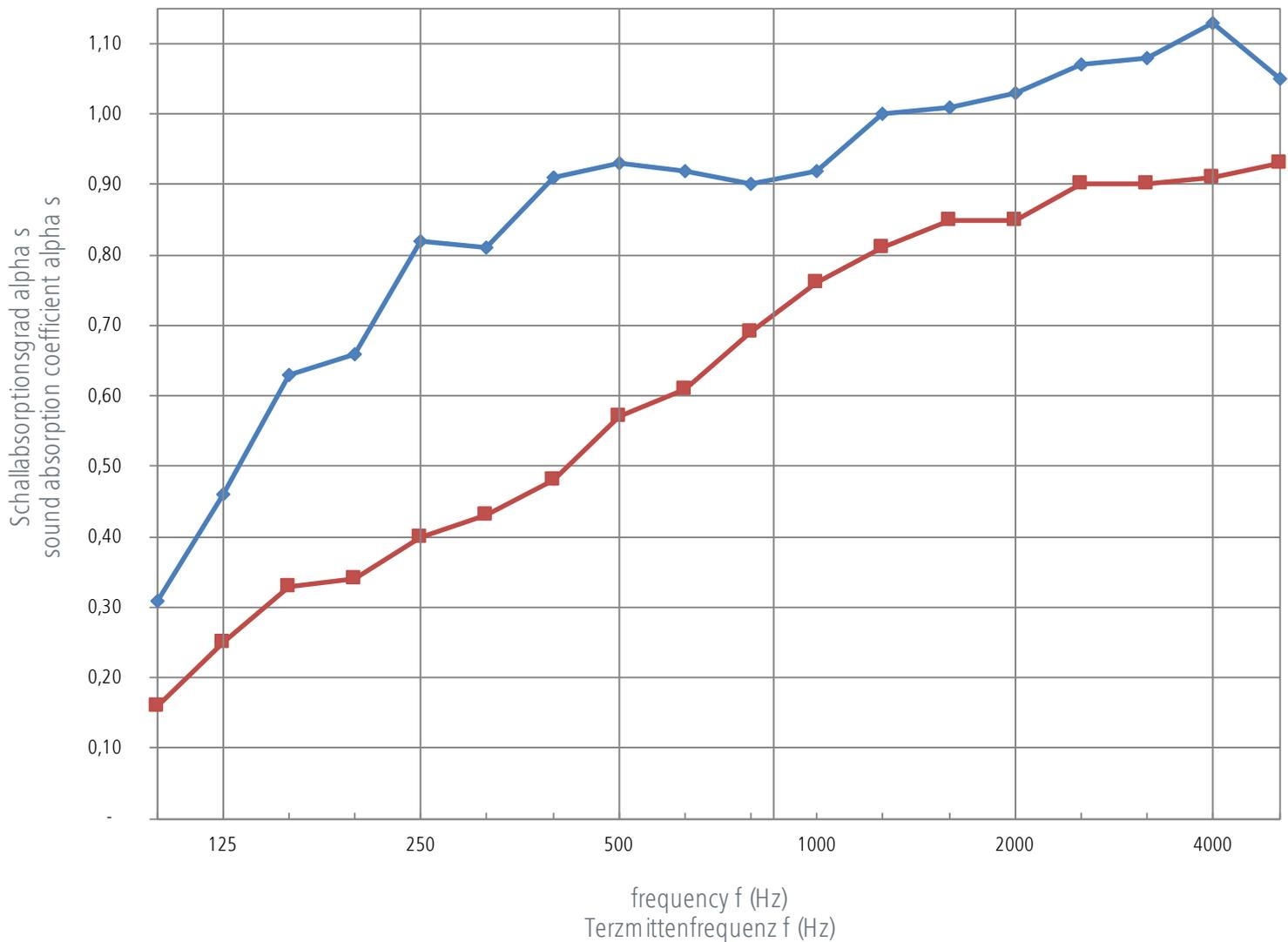
Das Produkt mira wurde nach den Richtlinien der DIN EN ISO 354:2003 und DIN EN ISO 11654:1997 im Prüflabor getestet.
